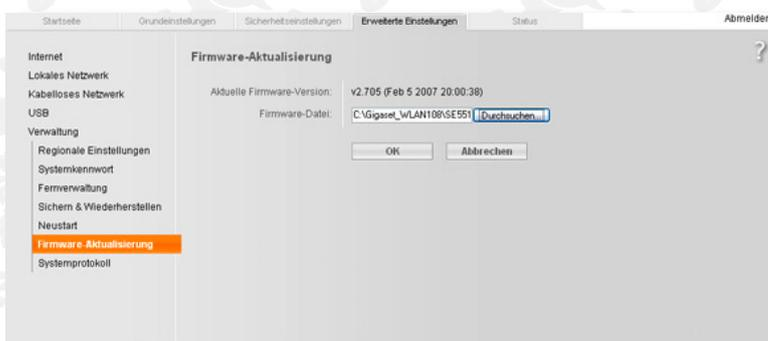
**Achtung!** Die Stromversorgung und PC-Verbindung zum Router darf während des Updates nicht unterbrochen werden! Wenn die Stromversorgung oder Verbindung zum PC im laufenden Update-Prozess unterbrochen wird, kann der Router möglicherweise beschädigt werden.
