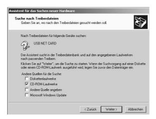
Klicken Sie die Option "CD-ROM-Laufwerk" an und vergewissern Sie sich, dass die Treiber-CD-ROM im CD-ROM-Laufwerk eingelegt ist!
