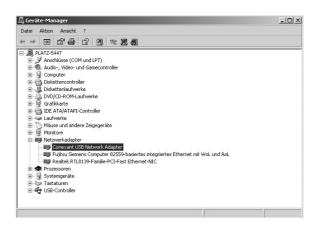
Unter dem Punkt "Netzwerkadapter" ist ein Eintrag "Conexant USB Network Adapter" vorhanden. Die Treiberinstallation ist erfolgreich abgeschlossen, wenn vor diesem Eintrag kein Warnhinweis steht.
