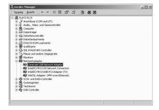
Unter dem Punkt "Netzwerkadapter" sollte sich nun der Eintrag "Conexant USB Network Adapter" befinden.
