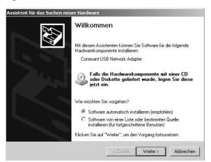
Wählen Sie die Option "Software automatisch installieren (empfohlen)" und klicken Sie auf *Weiter*.
