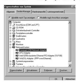
Unter dem Punkt "Netzwerkkarte" sollte sich nun der Eintrag "Conexant USB Network Adapter" befinden.
