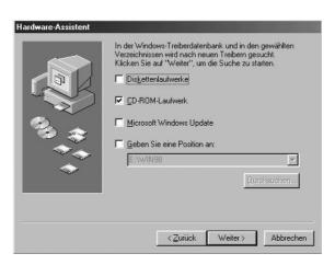
Klicken Sie die Option "CD-ROM-Laufwerk" an und vergewissern Sie sich, dass die CD-ROM für das NetDSL-Modem im CD-ROM-Laufwerk eingelegt ist! Klicken Sie dann auf *Weiter*.
