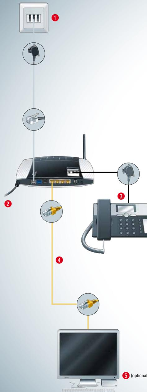
**1 VERBINDUNG DES ROUTERS MIT DER ANSCHLUSSDOSE (TAE)**
