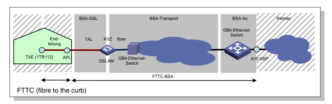
Für FTTC-BSA wird eine TAL vom KVz bis zu den Räumlichkeiten des Endkunden bereitgestellt. Die Beauftragung der TAL bei der TDG erfolgt durch die NetCologne. Für die Inbetriebnahme von FTTC-BSA sind bei der Standardbereitstellung keine Arbeiten beim Endkunden seitens NetCologne vorgesehen.
